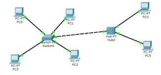
Cliquer sur le switch pour ouvrir sa fenêtre de propriétés, choisir l'onglet « physique » pour visualiser sa face arrière, commencer par éteindre le switch en cliquant sur le bouton I/O :
